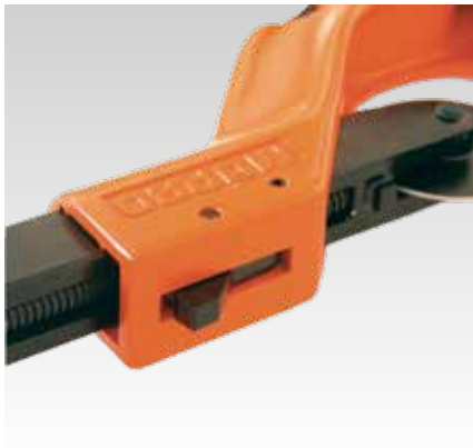
Schnellverstellung der Spindel
